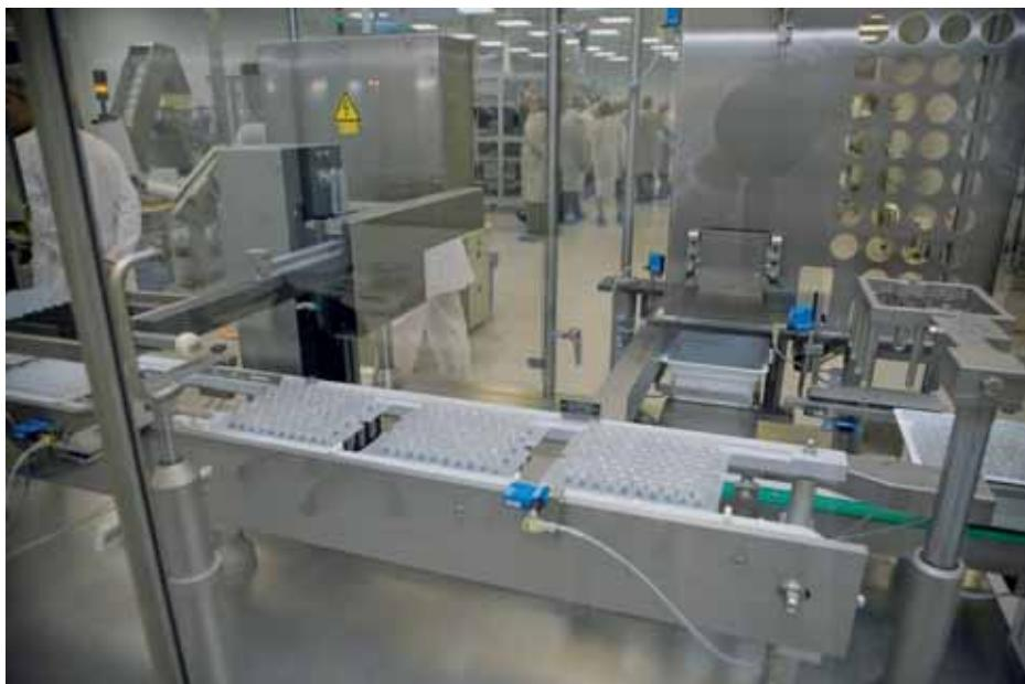
В этих процессорах происходит обработка полученных изображений и присвоение каждому шприцу статуса годного или бракованного. В соответствии с присвоенными значениями происходит автоматическая выгрузка из машины забракованных шприцев и накопление годных для передачи на последующие операции (вставка штока, этикетирование, упаковка и т.д.)
